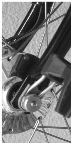
**L'axe de serrage doit toujours pouvoir être tourné au moins 5 tours dans l'écrou correspondant avant qu'une force de serrage ne soit nécessaire. En cas de doute, retirer les rondelles sur le côté droit.**
