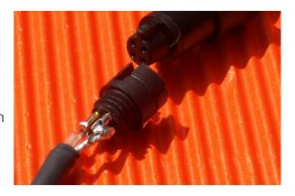
c) anschließend etwas säurefreies Fett auf die Lötstellen geben. Dann die Hülse und die Endkappe des Steckers mit leichter Handkraft aufschrauben. Zu viel Gewalt beim Aufschrauben der Endkappe kann das Kabel intern beschädigen.
